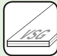
VSG besteht aus 2 Gläsern, die über eine zähelastische Folie miteinander verklebt sind. Im Falle eines Bruches bindet Verbundsicherheitsglas die Splitter. Diese Resttragfähigkeit liefert auch bei einer Teilerstörung einen Schutz vor Verletzungen und erschwert das Durchdringen des Glases (Basis-Einbruchschutz).
