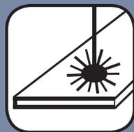
Bei der innovativen Lasergravur-Technik trifft ein Laserimpuls berührungslos und gezielt auf das Glas, wobei punktuell eine Art Oberflächenverschmelzung entsteht.
